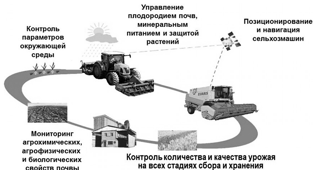
Рисунок 2 — Основные элементы системы точного земледелия (составлено авторами)
